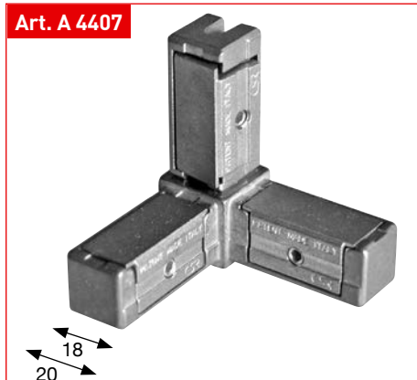
Giunto angolare in zama a 3 vie: 20 mm esterno/18 mm interno
