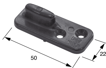
Art. A 641 Pattino nero in nylon 50x22 mm per ante scorrevoli con cava da 8 mm. Per Serie 30 e Serie 45.
